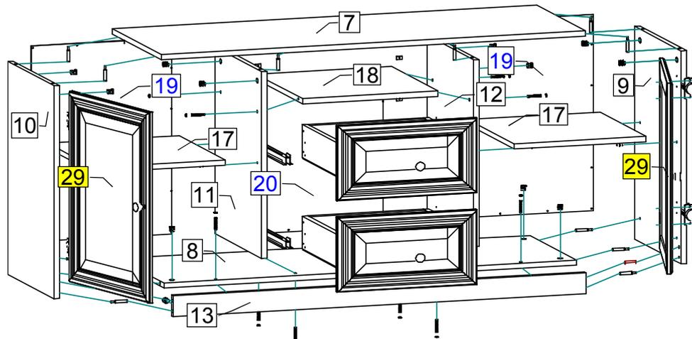
При помощи евровинтов (поз.54) присоедините панели вертикальные поз.11,12,13 к панели горизонтальной поз.8. Закрепите в с помощью евровинтов (поз.54) полку поз.18.
