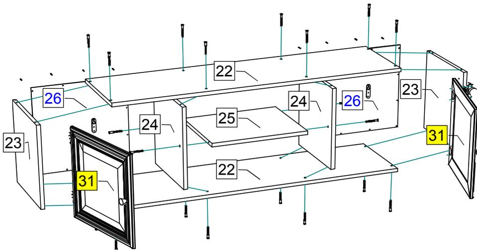
Шурупами 3,5x16 (поз.69) на двери поз.31 закрепите петли (поз.57). Навесьте и отрегулируйте двери поз.31.
